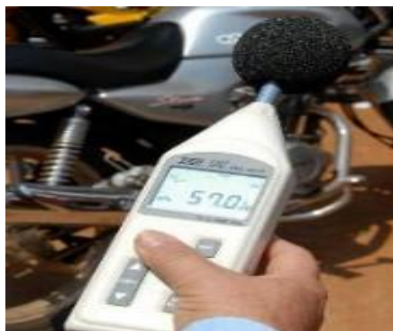
Uso de sonómetros para control de ruido.
